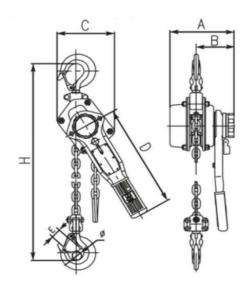
Der TOPline Ratschenzug ist ein besonders hochwertiges kompaktes und leichtes Hebewerkzeug
